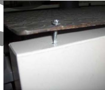
Fijar los laterales con los paneles superiores como se indica.
